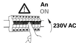
**Schalten Sie die Spannungsversorgung ein.**
